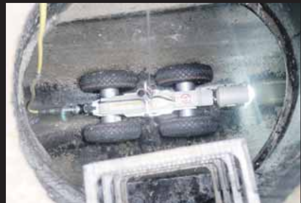
Kamera putuje kanalizacijskim cjevovodom
